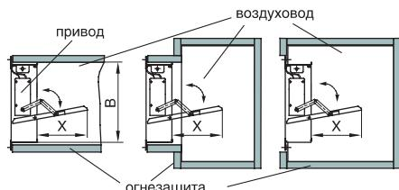
При установке в торце воздуховода установочные размеры клапана должны быть меньше соответствующих внутренних размеров воздуховода.
