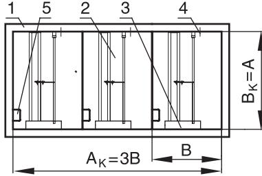
Кассеты из КЛАД®-3 изготавливаются из клапанов, корпус которых выполнен из окрашенной холоднокатаной стали.
