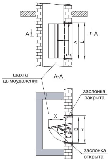
Горизонтальная ориентация размера А клапана
