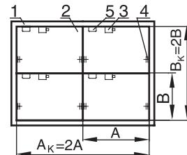
$A_K$ ,  $B_K$  – установочные размеры кассеты, мм1 – корпус клапана; 4 – ось заслонки;
