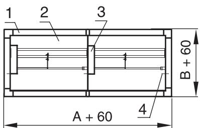
Типоразмерные ряды «канальных» клапанов КЛАД®-2(КДМ-2) с внутренним размещением приводов BELIMO и кассет из этих клапанов аналогичны типоразмерным рядам «стеновых» клапанов и кассет (см. стр. 21).
