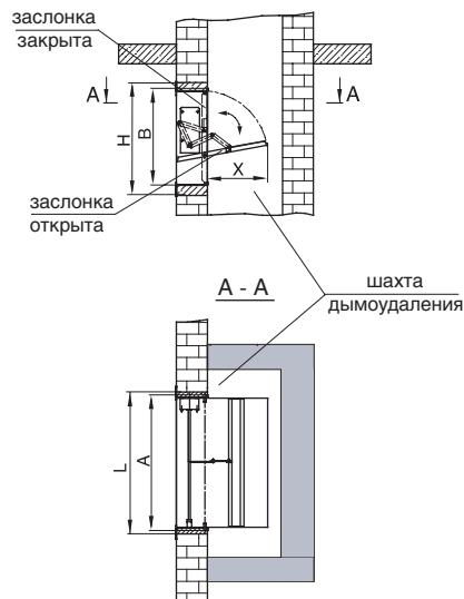
При горизонтальной ориентации размера А электромагнитный привод должен быть расположен сверху, а привод BELIMO – слева (см. схемы на стр. 17).
