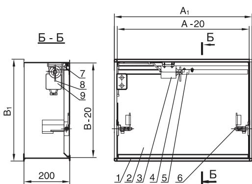
Для обеспечения закрывания заслонки клапан следует устанавливать в торце воздуховода.
