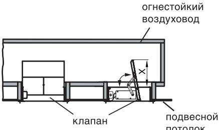
Размеры монтажного проема:  $L=A+10\ldots20$  мм;  $H=B+10\ldots20$  мм
