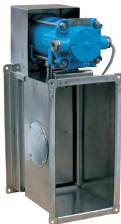
Клапаны для районов с морским климатом изготавливаются из нержавеющей стали. Электромеханический или реверсивный привод BELIMO помещен в оболочку, имеющую степень защиты IP 66. Корпус клапанов выполняется прямоугольного сечения.
